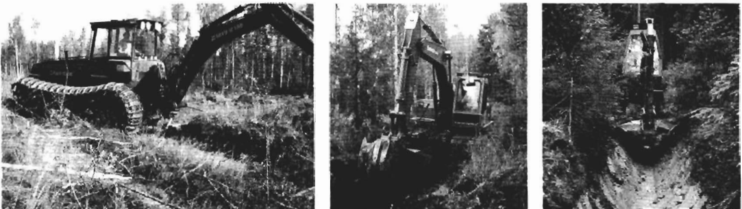
Kuva 1. Tutkimuksessa mukana olleet konetyypit. Vasemmalla oikealle kaivuri, kaivinkone, yksitelainen pienkaivuri.
