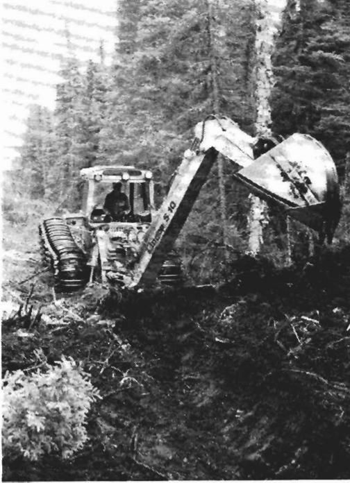
Kuva 2. Tyypillistä kaivumaastoa: turvetta puoli metriä ja alla puhdas savi. Kaivurina Lännen S-10.
