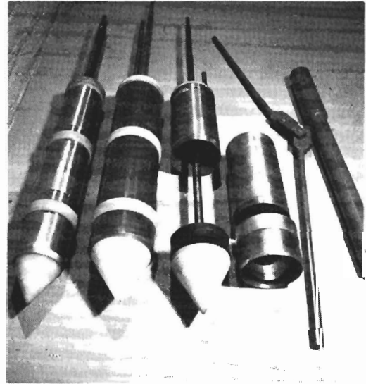
Kuva 1. Kolme eri versiota tilavuustarkkoja turvenäytteitä ottavasta turvekairasta. Keskellä muovinen kaira. Oikealla näytteenotossa käytetyt pihdit ja juntta. Tarkempi selostus tekstissä.
