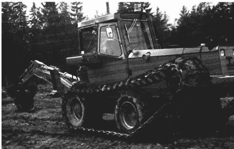
Kuva 2. Metsäojituskaivurin kehittäminen ojanperkauskoneeksi on ollut metsäojien perkauksen koneellistamisen keskeinen kysymys. Viimeisin saavutus tällä linjalla on liikkumispuolta myöten täyshydraulinen kaivuri. Tällainen on uuden sukupolven kaivuri (kuvassa LÄNNEN UM 3) soveltuu hyvin metsäojien perkauksessa käytettävään höyläyskaivuun ja suoriutuu sen lisäksi kaikista perinteellisistä metsäojituskaivurin tehtävistä.
