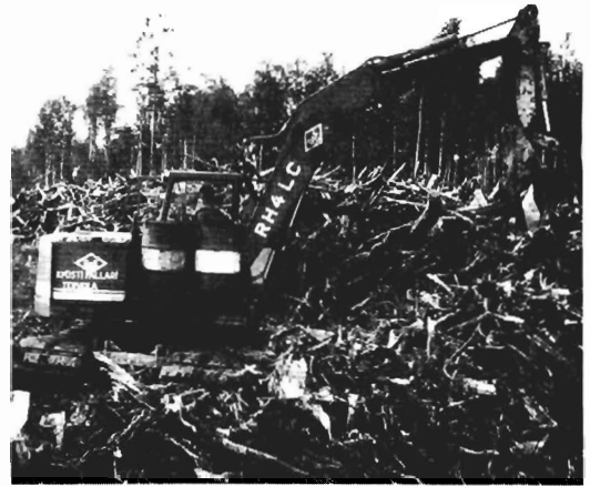
Kuva 5. Pallarin kanto- ja liekopuun harvesteri kanto- ja liekopuun paloittelussa.
