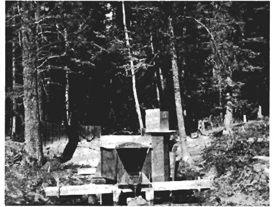
Kuva 2. H-tyyppinen valunnamittauskouru (syvyys 61 cm). Valuntaa mitataan 35 hehtaarin laajuiselta valuma-alueelta, josta 8 hehtaaria on suota.
