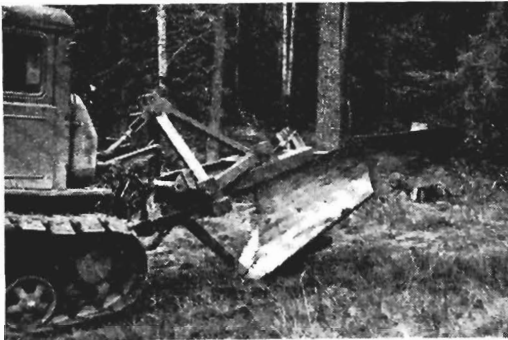
Kuva 8. Metsänviljelyssä käytetty turpeen-kääntöaura PKLN-500.
