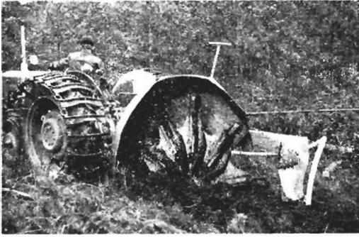
Kuva 1. Entisestä Nars-jyrsimestä parannettu kotimainen kiekkojyrsin, josta voidaan kaivun yhteydessä laskea joustavaa, muovista salaojaputkea. Valok. R. Halonen
