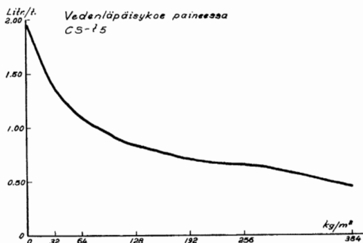
Kuva 3. Turpeen vedenläpäisevyykoe eri paineoloissa.
