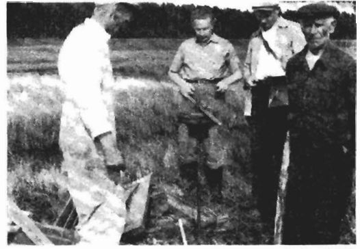
Kuva 3. Lieju- ja savikerrosten vahvuudet määritetään painokairalla Kavajärven vesijätöllä Urjalassa.
