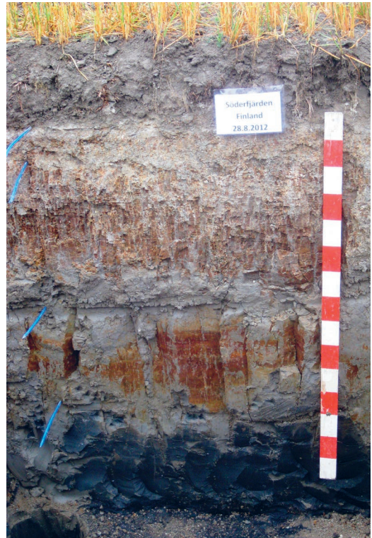
Kuva 2. Rikkipitoisten maakerrosten kuivatuksen seurauksena muodostunut hapan sulfaattimaa -profiili pelto- maassa. Ylimpänä näkyvän muokkauskerroksen alla on paksu hapettunut kerros, jossa näkyy ruosteenvärisiä saostumia. Syvemmällä, pohjaveden pinnan alapuolella on muuttumatonta tummanharmaata rikkipitoista maata. Kuva: Markku Yli-Halla.
