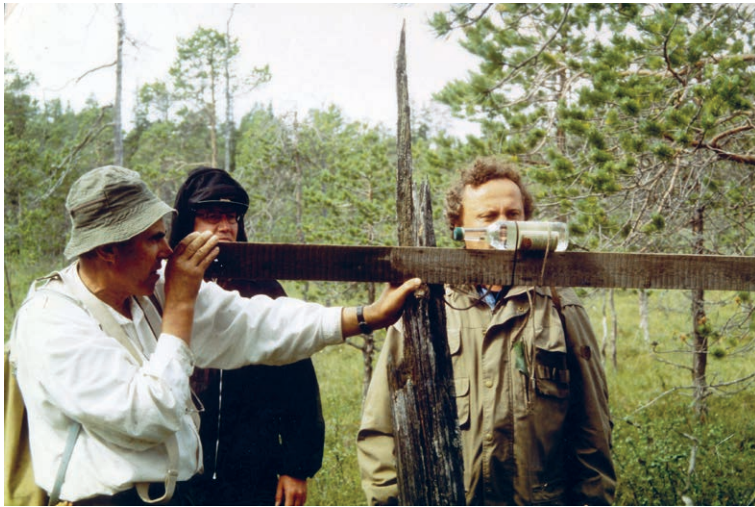
Kuva 14. Suon vaaitusta vodkapullomenetelmällä Solovetskissa Venäjällä vuonna 1997. Kuvassa Kimmo Tolonen tähtää, Harri Vasander tarkkailee kuplaa pullossa ja Barry Warner huutelee ohjeita lattamiestä vastaavalle avustajalle (ei kuvassa), joka merkitsee tähtäyksen tason korkeutta maastoon. Kuva: Tapio Lindholm.
