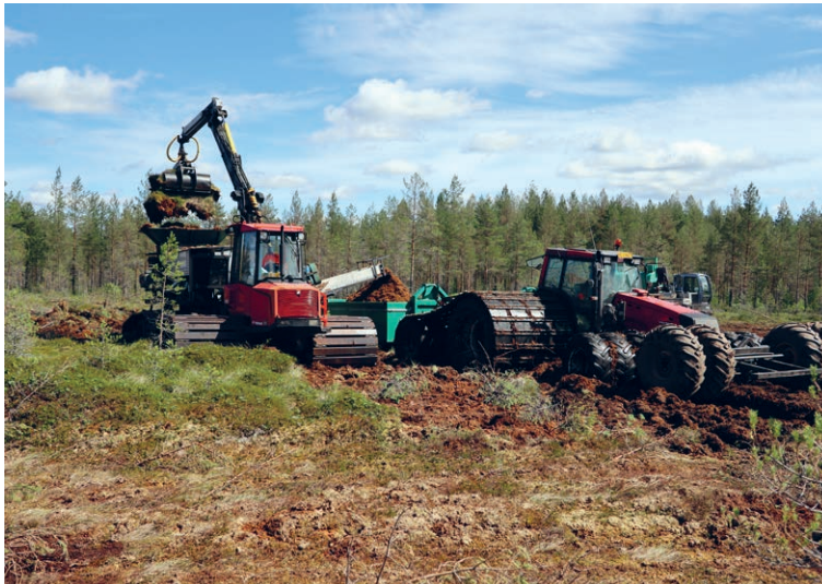
Kuva 2. Rahkasammalbiomassan kesäkorjuuta Peräseinäjoen Limingannevalla heinäkuussa 2019. Korjuuketjuun kuuluu erikoisvalmisteinen, erityisesti rahkasammalbiomassan korjuuta varten metsätraktorialustalle rakennettu korjuukone puristimiseen ja kuljettimiseen sekä maataloustraktorista muunneltu ajokone. Sekä korjuu- että ajokone on varustettu erikoisleveillä teloilla (Kuva: Hannu Salo).
