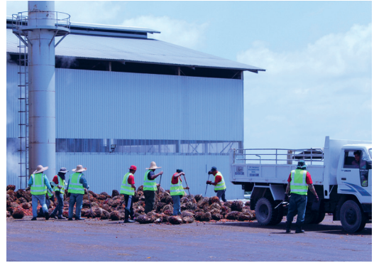
Kuva 10. Jälleen yksi kuorma-autollinen öljypalmuntertutuja ja kipattu tehtaan pihalle työntekijöiden esilajiteltavaksi Ensengein jalostamolla. Kunnolliset tertut heitetään luisikan kautta syöttöhihnelle kohti jalostuksen ensimmäistä vaihetta, puhdistamista ja edelleen hedelmien irrottamista kukkaperästä.
